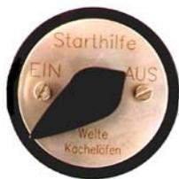
Wenn ungünstige Zugbedingungen vorhanden sind, wird eine Anheizklappe mit eingebaut. Diese ermöglicht einen direkten Rauchabzug in den Schornstein, wenn sie geöffnet wird. Dadurch können die Gase auch bei kaltem Schornstein problemlos abziehen. Die Anheizklappe muß nach einigen Minuten wieder geschlossen werden, sobald der Schornstein warm ist.
